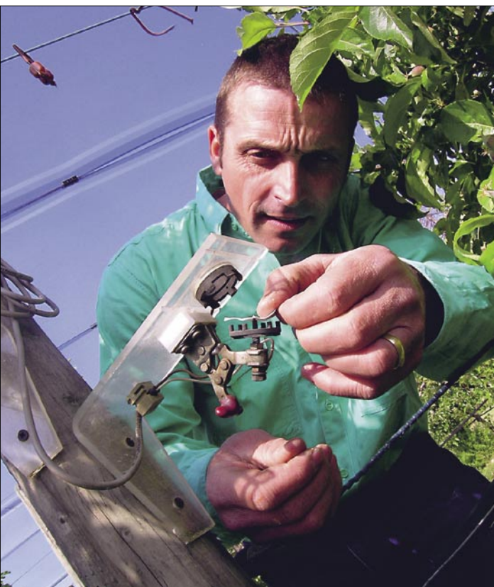
Un entretien consciencieux de la station météo est indispensable pour que celle-ci fournisse des données fiables. Chr. Suter change ici un papier buvard simulant le degré d'humectation du feuillage.
